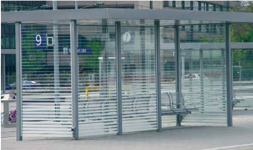
Wartehäuschen, kleine Lärmschutzwände, Windschutz-Verglasungen, Balkon-Brüstungen etc. lassen sich auch nachträglich gut mit horizontalen oder vertikalen Streifen ausrüsten. Dieses Objekt in München wurde von Beginn weg mit Siebdruckglas ausgerüstet.
