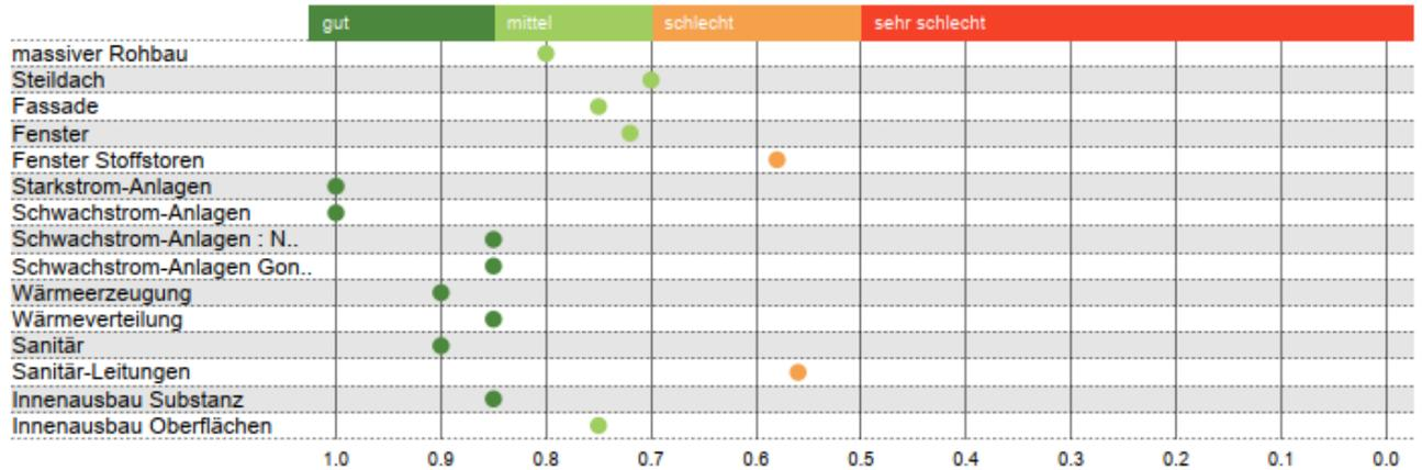
Die nachfolgende Grafik zeigt den errechneten Instandsetzungszeitpunkt gemäss Stratus aufgrund der Zustandsbeurteilung:
