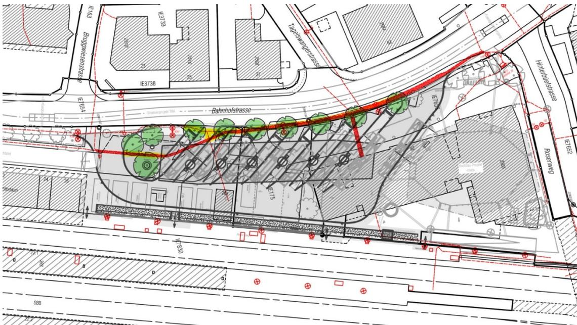
Abbildung 56: bestehende Stromleitungen und Werkobjekte rot, projektierte Bäume grün, gelb markiert Konflikt mit Baumgruben.
