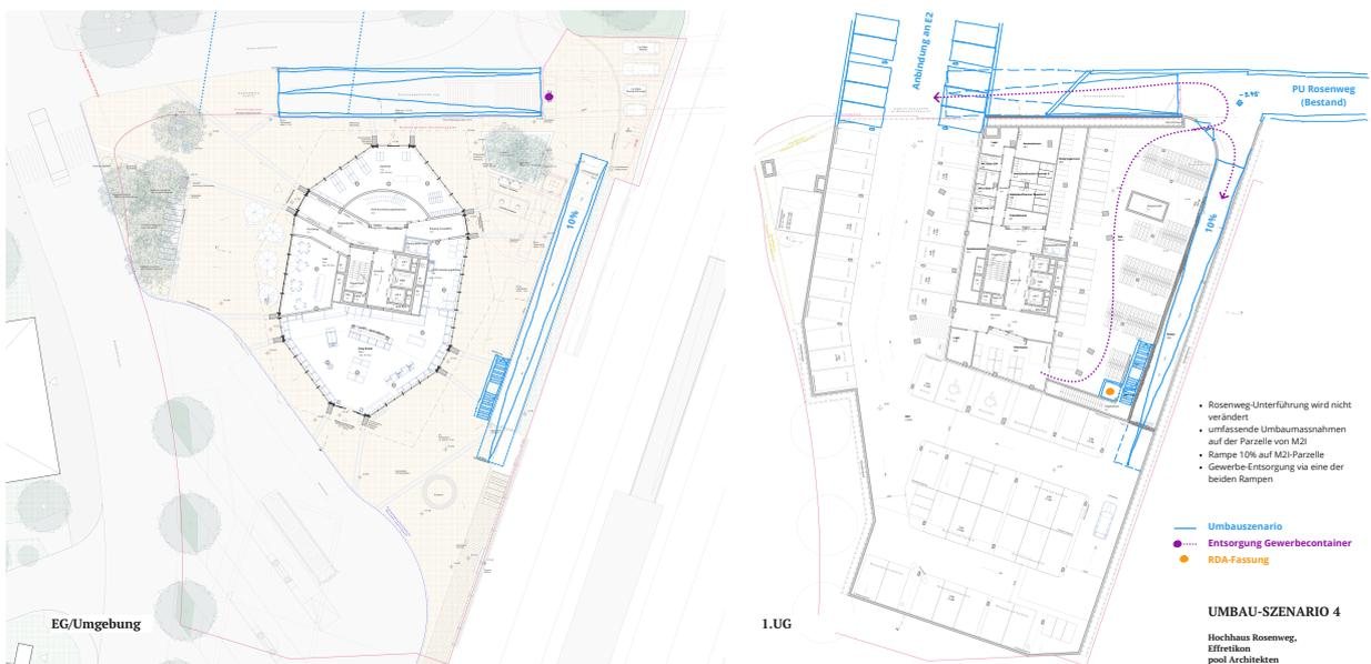
Abbildung 59: unterirdische Erschliessung der Tiefgarage und neuer Zugang zur Personenunterführung
