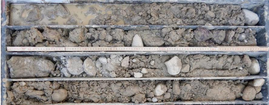
Abbildung 5: RKB 20-2. 5.0 – 5.6 m: Seeablagerungen, glazial; 5.6 – 9.0 m: Moräne, aufgelockert.
