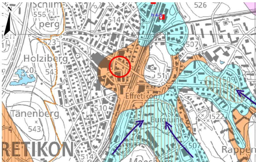
Abbildung 8: Grundwasserkarte (Hochwasserstand) [3] mit Lage des untersuchten Grundstücks (Arealmitte: roter Kreis). Legende: hellbraun: geringe Grundwassermächtigkeit oder geringer Durchlässigkeit; hellblau: mittlere Grundwassermächtigkeit; Schraffur: schlecht durchlässige Deckschicht (meist > 5 m). Ohne Massstab, aktueller Stand
