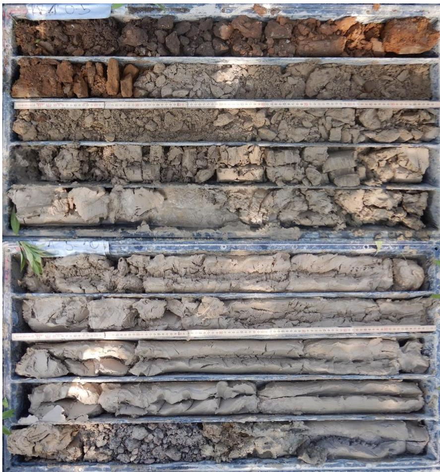
Abbildung 4: RKB 20-1. 0.0 – 0.5 m: Oberboden; 0.5 – 1.2 m: Schwemmsediment; ab 1.2 m: Seeablagerung, glazial.
