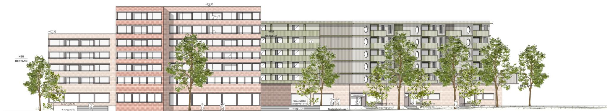
Ansicht von Osten entlang Rikonerstrasse - Der Bestand im Teilbereich 2 wird erweitert und geklärt im Sinne von Erhalten und Verdichten. Die neuen Loggien rhythmisieren die Bestandsfassade im Teilbereich 2 und lockern diese auf. Der hohe Sturzbereich bleibt erhalten, weil der Bestandssockel vom Teilbereich 1 ebenfalls über einen hohen Sturz verfügt.
