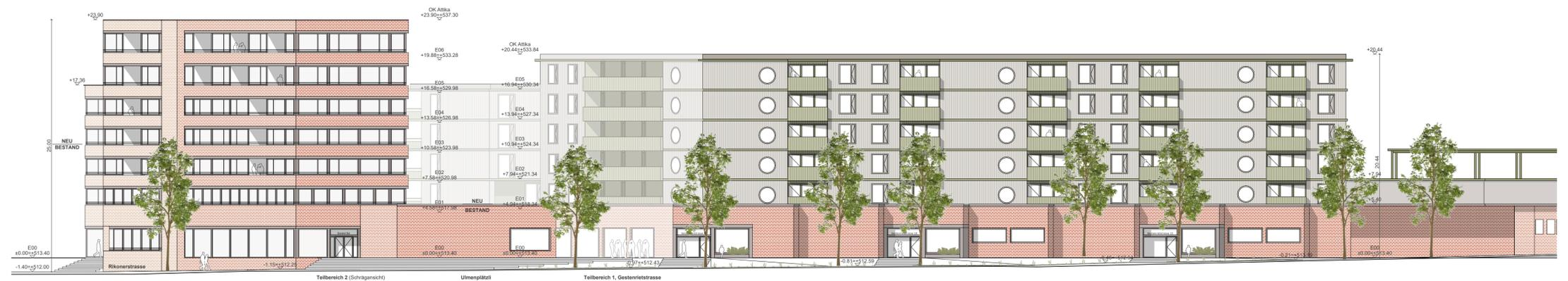
Ansicht von Norden entlang der Gerstenrietstrasse - Teilbereich 1 erhält eigene Adressierung, eigene Tektonik und Fassadengestaltung. Die neuen Wohnungseingänge im Sockelbau werden, in Variation zu den Büroeingängen, mit einem breiten Blechrahmen betont. Zurückgesetzt in der Nische entsteht eine intime und geschützte Eingangssituation. Der Bestand des Teilbereichs 2 wird weitergebaut und erhält Loggien im Bestandsbau sowie eine Aufstockung von zwei Geschossen.
