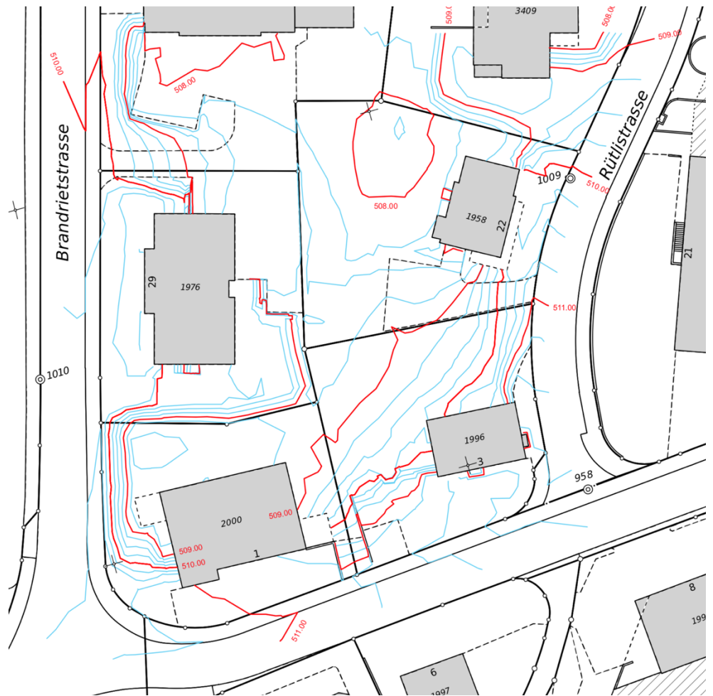
Höhenkurven (Äquidistanz 25 cm) des bestehenden Geländes, Quelle: ewp AG
