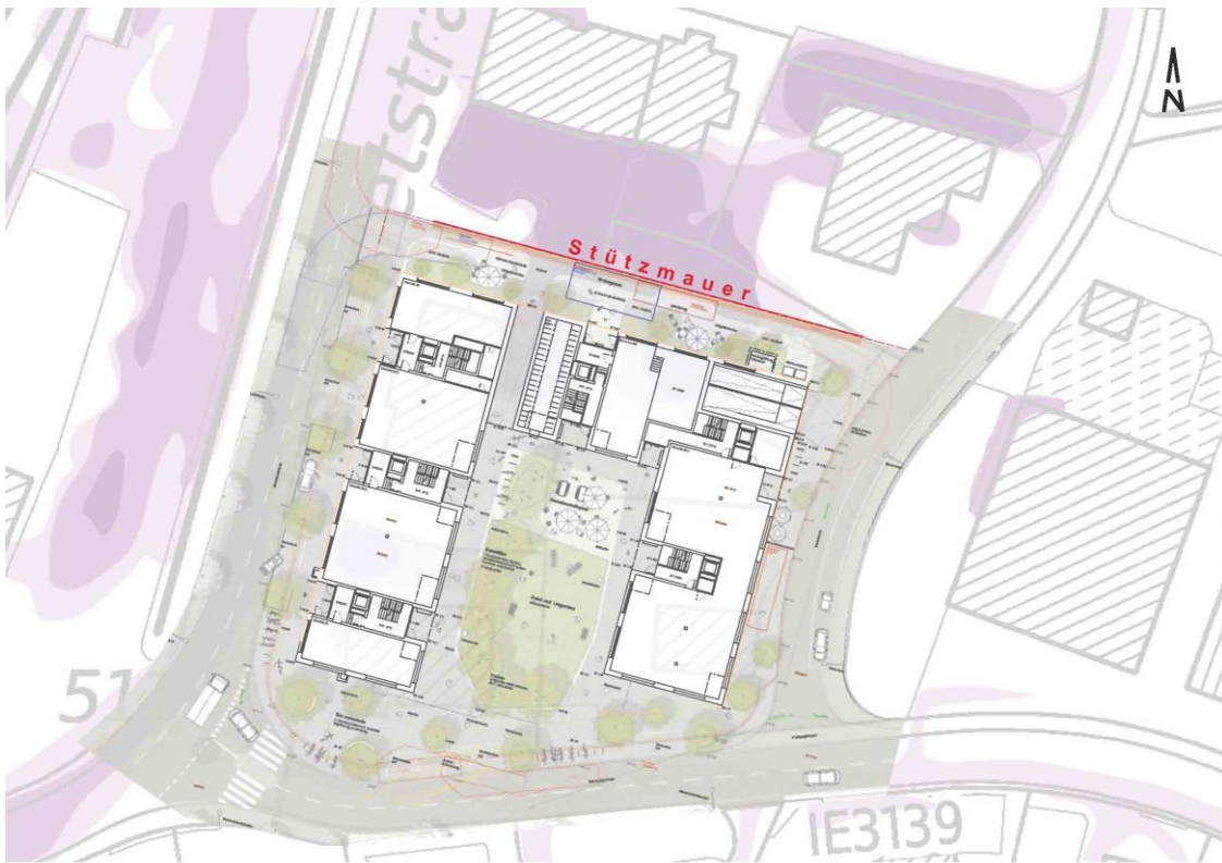
Abbildung 4: Richtprojekt Freiraum mit Lage Stützkonstruktion als Wasserbarriere (Hintergrundbild: Karte Oberflächenwasserabfluss)
