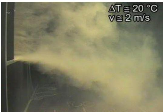
Bild 1: Luftströme bei einem Drehfenster
