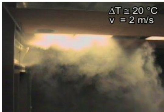
Bild 2: Luftströme bei einem Kippfenster
