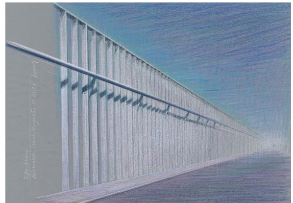
d) Variante mit aussen befestigtem Geländer, Innenansicht
