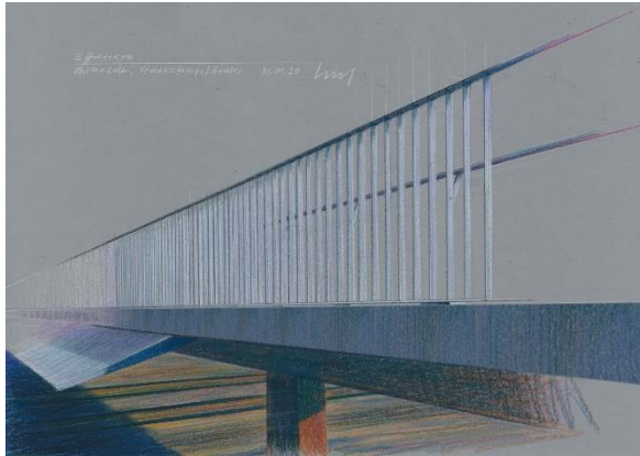
a) Variante mit oben aufgesetztem Geländer, Aussenansicht
