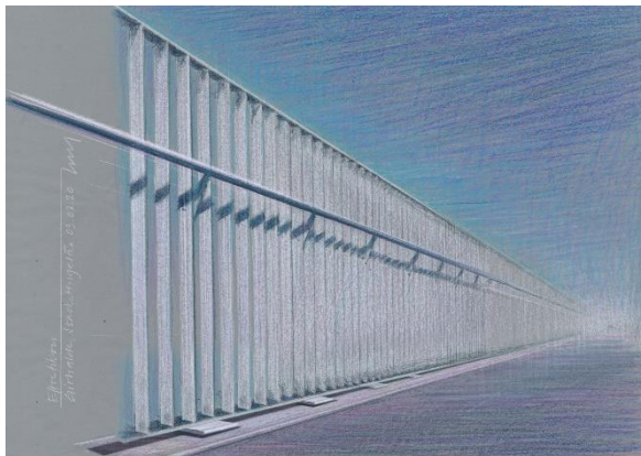
c) Variante mit oben aufgesetztem Geländer, Innenansicht
