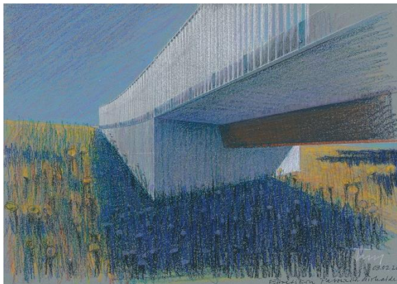
c) Variante mit Staketengeländer, Widerlager und Brückenträger in einer Flucht, Geländer aussen an Konsolkopf befestigt.
