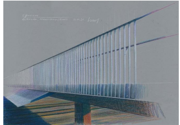
b) Variante mit aussen befestigtem Geländer, Aussenansicht
