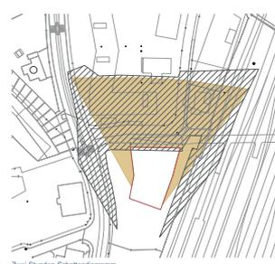
Der nachgewiesene 2-Stundenschatten zeigt die maximal zulässige Gebäudeschattensituation bei voller Höhe auf, mit Überlagerung des Regelschattens. Vorliegender Entwurf übertrifft eine auf die Regelbauweise hinausgehende Verschattung nicht. Dies ist auch der Fall für Grundstücke ausserhalb des Masterplansystems.
